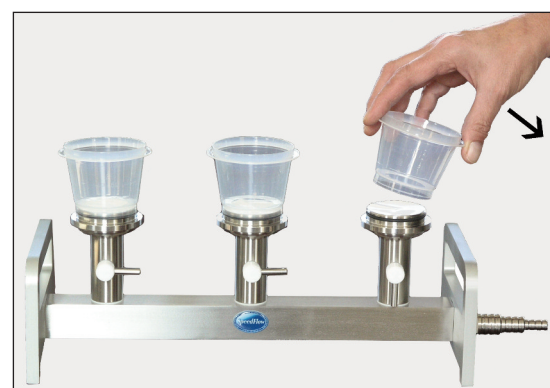
Rimozione del filtro
