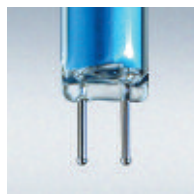
Particolare dell'elettrodo BS02PH con 2 puntali in platino ad ago
