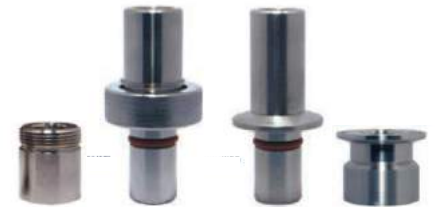
4572600 - 726-W0 con ghiera per montaggio su bocchettone ø 25 mm, per elettrodi H= 120 mm tipo S8
