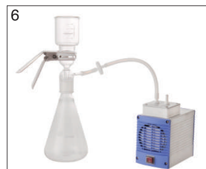
6 Pompa e sistema filtrante tutto vetro per prodotti corrosivi
